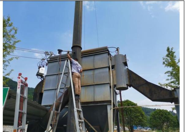
锅炉废气排气筒采样照片
