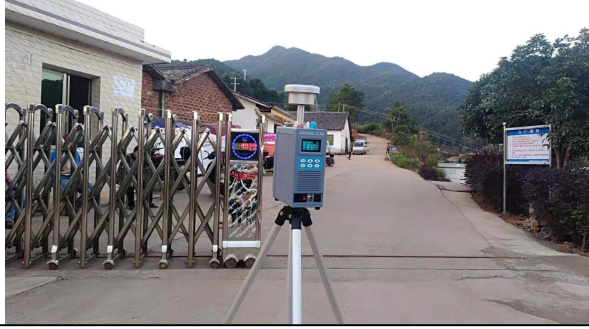
无组织废气采样照片
