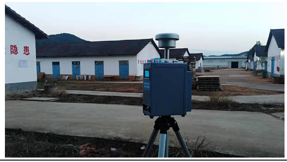
无组织废气采样照片
