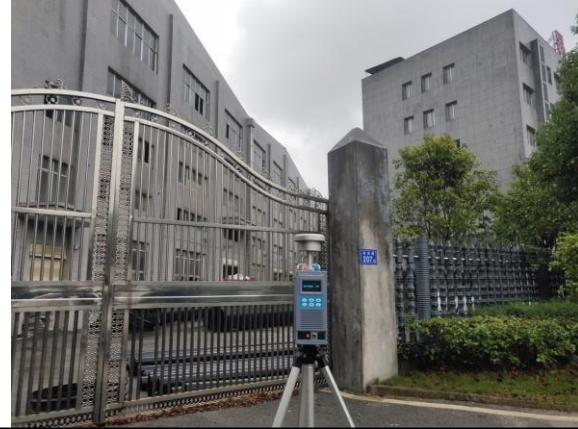
无组织废气采样照片 1
