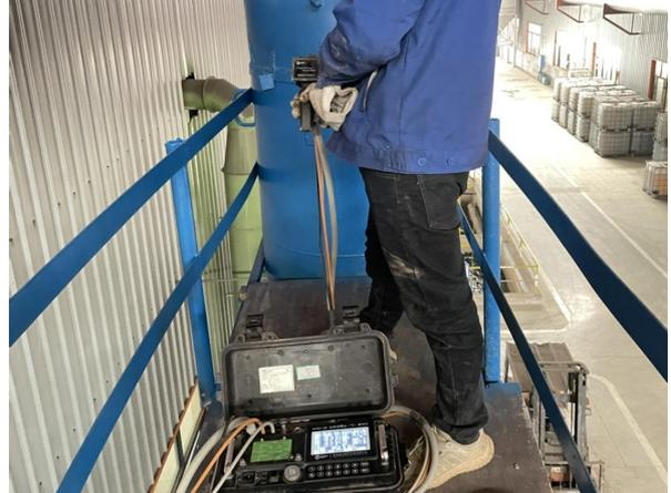
混砂、砂处理排气筒 (DA003)：出口
