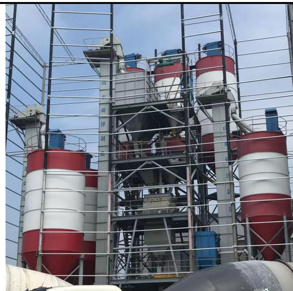
干混砂浆生产线自带除尘设施
