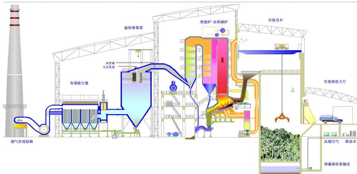
图 4-2 废气处理工艺流程图
