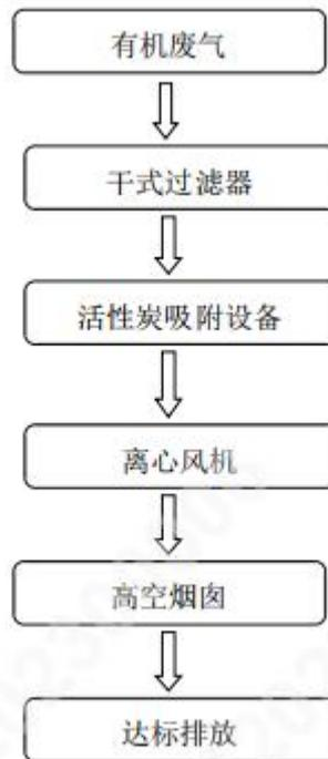
图 4-1 注塑有机废气处理工艺流程图
